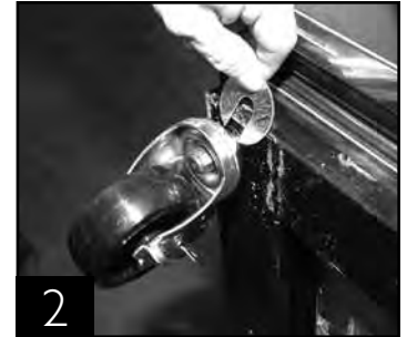
2 Para nivelar inserte la cuña entre la base del gabinete y la de la rueda.
