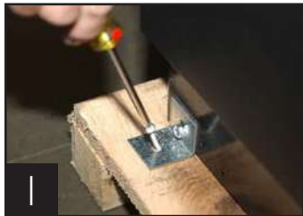
1 Removiendo el soporte de la paleta.
