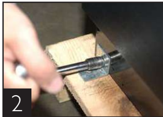
2 Removiendo el soporte del gabinete.
