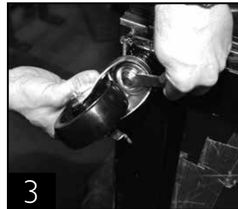
Use la herramienta que se suministra para apretar las ruedas.
