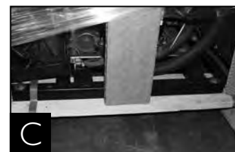
Removiendo la paleta de la parte inferior del gabinete.
