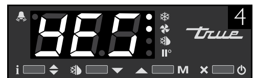
Imagen 4. Si la palabra "yes" aparece en la pantalla, el controlador está bloqueado
