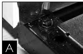
Removiendo la paleta de la parte inferior del gabinete.
