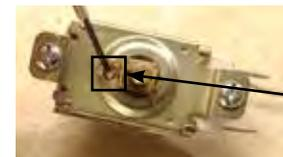
Para ajustar el control de temperatura, quite la perilla del control para ver el tornillo de encendido. (Ver la imagen de arriba).
