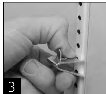
Tal vez deba apretar o torcer la parte inferior del gancho para las parrillas para poder colocarlo.
