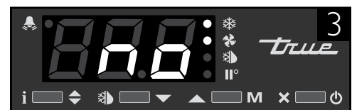
Imagen 3. Si la palabra "no" aparece en la pantalla, el controlador está desbloqueado..
