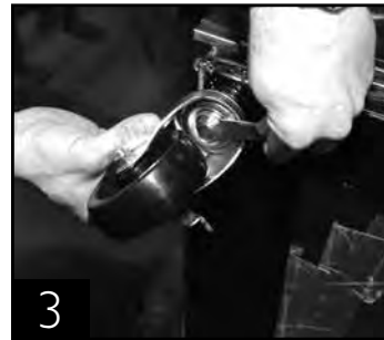
3 Use la herramienta que se suministra para apretar las ruedas.
