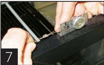
Soporte de la roldana de la puerta con cable metálico.
