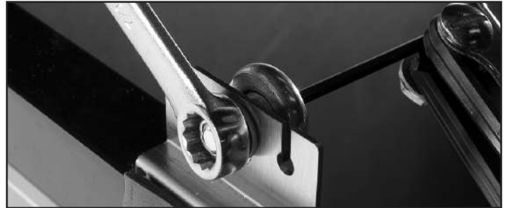
Fig. 1. Adjust the roller.
