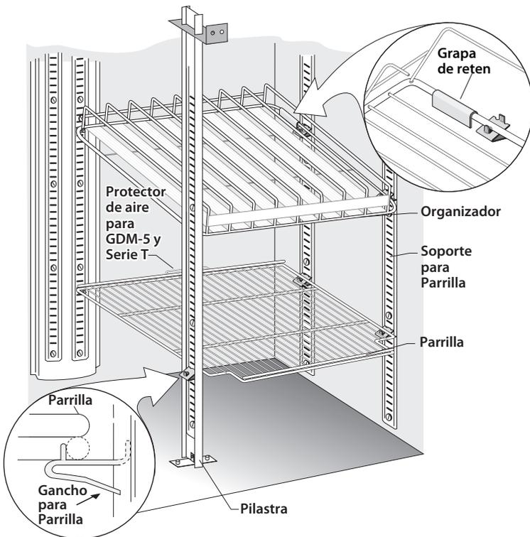
**NOTA:** Los modelos de la serie T y el modelo GDM-5 incluyen un protector de aire en la parte trasera de las parrillas, con el fin de mantener un espacio de aire en la parte trasera del gabinete. (Ver ilustración).
