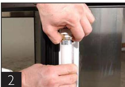
Los soportes de la lámpara están activados por resortes. Hale el soporte superior hacia arriba y empuje la lámpara hacia abajo al mismo tiempo. Esto le dejará suficiente espacio para remover la lámpara.
