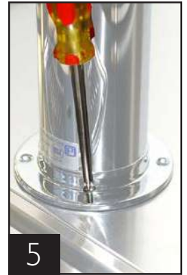
3 Atornille el conector de la línea de cerveza al brazo del dispensador. Fije el dispensador a la unidad y asegúrese de que el empaque de goma quede situado en la base del brazo dispensador
