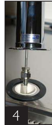
3 Atornille el conector de la línea de cerveza al brazo del dispensador. Fije el dispensador a la unidad y asegúrese de que el empaque de goma quede situado en la base del brazo dispensador
