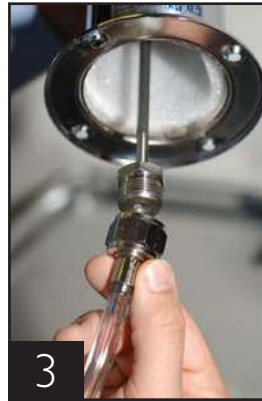
3 Atornille el conector de la línea de cerveza al brazo del dispensador. Fije el dispensador a la unidad y asegúrese de que el empaque de goma quede situado en la base del brazo dispensador
